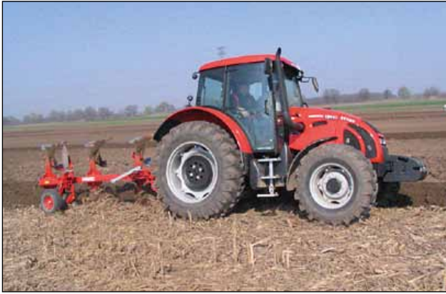
A legerősebb 12441-es Zetor Forterra traktor 3 ekefejes Sukov váltva forgató ekével végzett mélyszántást
