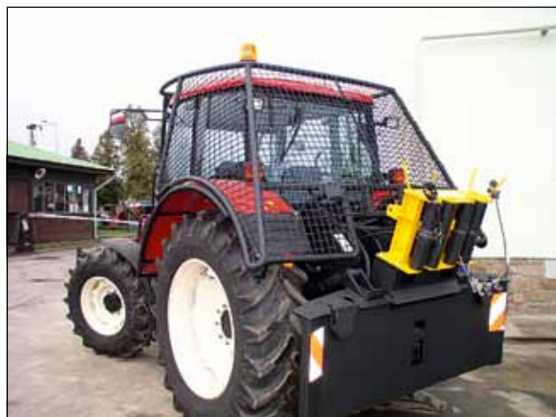
Forterra + DTN-4 kétdobos csörlő
